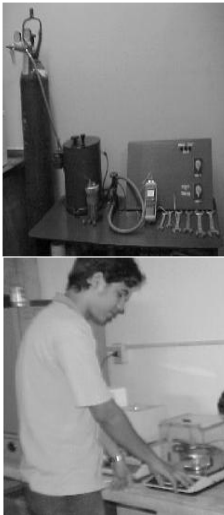
Figura 4. Bancada para medição de poder calorífico
