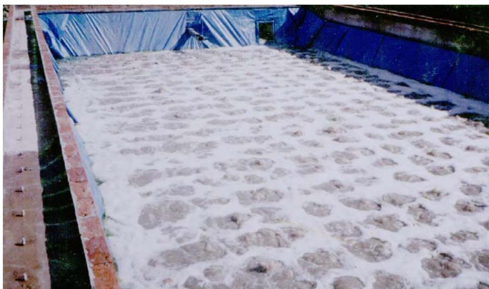
Figura 1. Demonstração do efeito do agitador cinético em biodigestor tubular sem o gasômetro.
