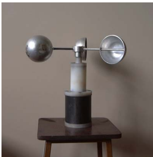
FIGURA 1– ANEMÔMETRO DE CONCHA
