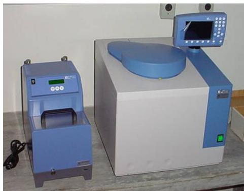
Figura 2 – Bomba calorimétrica digital
