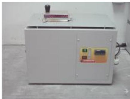
Figura 3 – Forno mufla vertical
